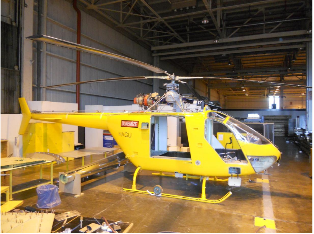
Şekil 1. İTÜ-HTH, Palalar, Motor, transmisyon ve kontrol sistemi yerleştirilmiş durumda.
