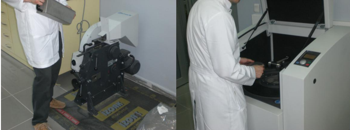
Foto 8: numunelerin XRF için hazırlanmasını sağlayan füzyon eritiş cihazı
