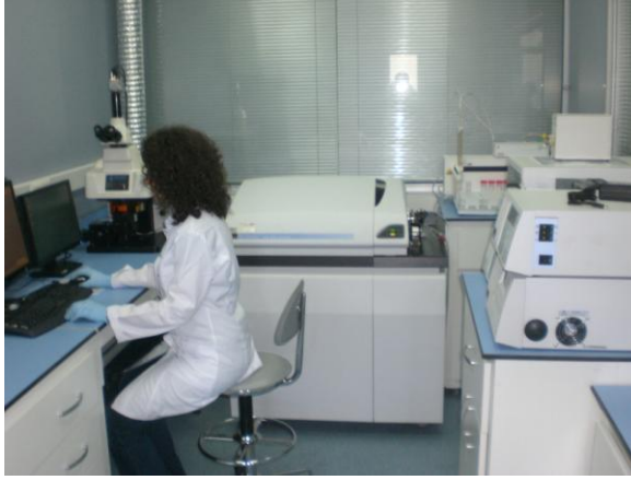
Foto 6: Cleanroom içinde konuşlandırılan LA-ICP MS cihazı ve HPLC Foto 7: 12 hazneli otomatik kontrollü mikrodalga cihazı
